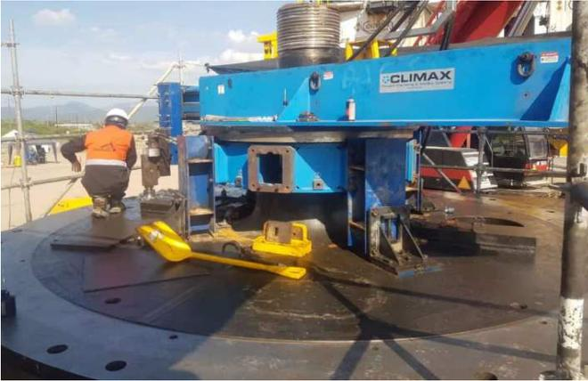
Izq: *fresado del asiento para el rodamiento de giro en el carbody de una pala P&H, montada en la cara (FM) y con "poca" (<90") distancia entre los puntos de apoyo.*
